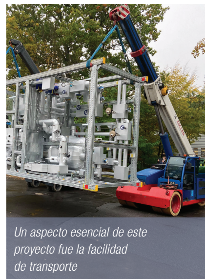
Las conexiones atornilladas permiten realizar modificaciones en cualquier momento
