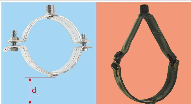
Figura 6.3: Abrazadera Stabil D-3G antes y después del ensayo / Sikla
