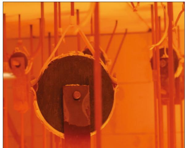
Figura 6.2: Abrazadera en un ensayo contra incendios / Sikla
